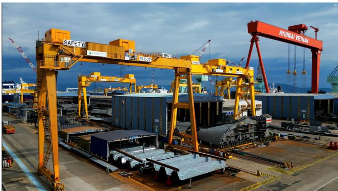
Hình 1.4. Cầu trục Goliath 750 T của nhà máy
